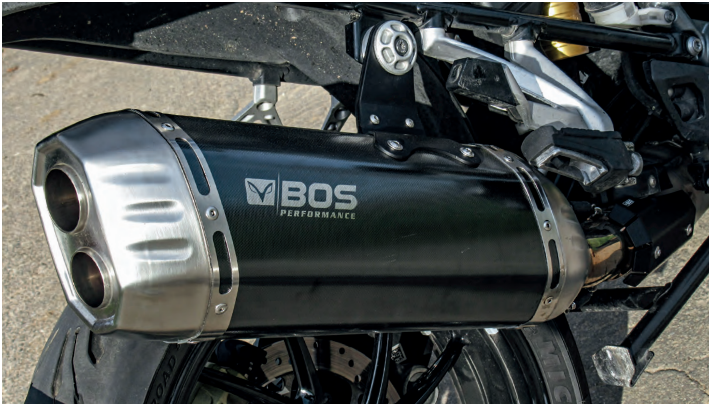
Auch der BOS Desert Fox endet mit zwei übereinander angeordneten runden Mündungen. „Carbon Steel“ ist Edelstahl im Carbon-Look
