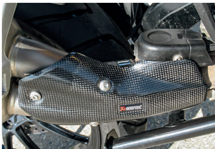
Titan-Doppelrohr am Verbindungsrohr, passgenaue Carbon-Abdeckung
