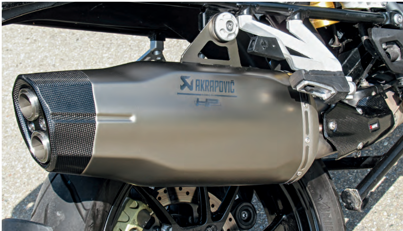
Carbon und Titan – ziemlich viel Titan. Der HP-Schalldämpfer von Akrapovic ist kaum weniger voluminös als das Standardteil und auch nicht leichter, sogar 100 Gramm schwerer
