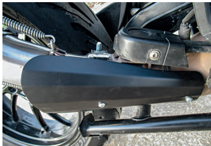
Verbesserungsvorschläge von uns an MIVV: Bitte etwas längere Spannfedern beilegen, Form und Ausrichtung des Abdeckblechs überarbeiten
