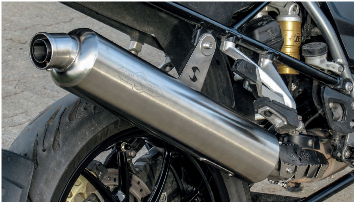
Edelstahl rustikal aus dem schwäbischen Ringingen. Das Hattech-Design erinnert an die 1990er Jahre. Angeschweißte Aufhängelasche, einfacher Anbau
