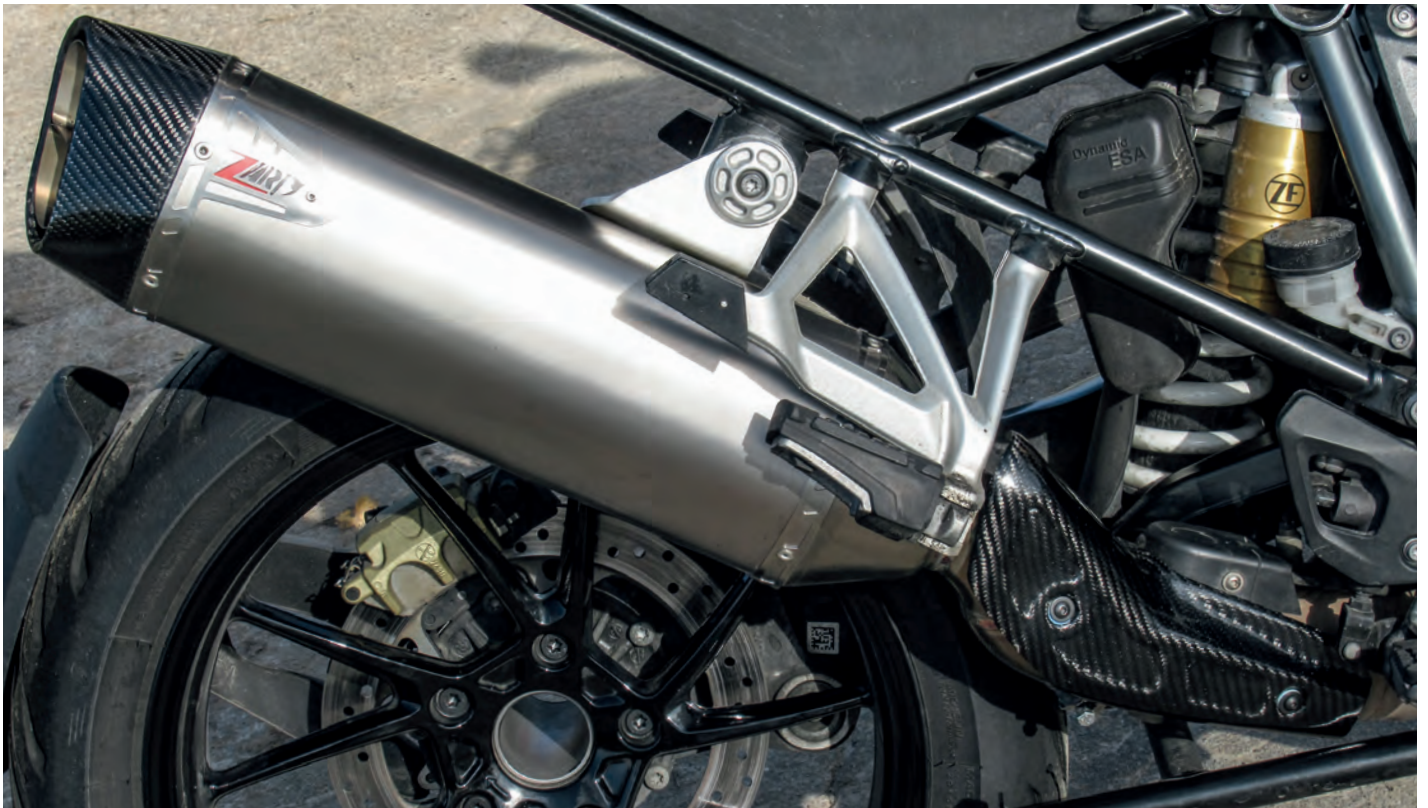
In der Seitenansicht zu erkennen: die schräge Carbon-Endkappe. Angeschraubte dicke Aufhängelasche. Carbon-Abdeckung am Verbindungsrohr mit umständlich verlegter Gewindeaufnahme, an der Klappensteuerung zu eng
