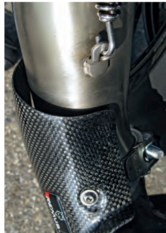
Die Form der Carbon-Endkappe erklärt die Bezeichnung „8“. Abdeckung am Verbindungsrohr ebenfalls aus Carbon
