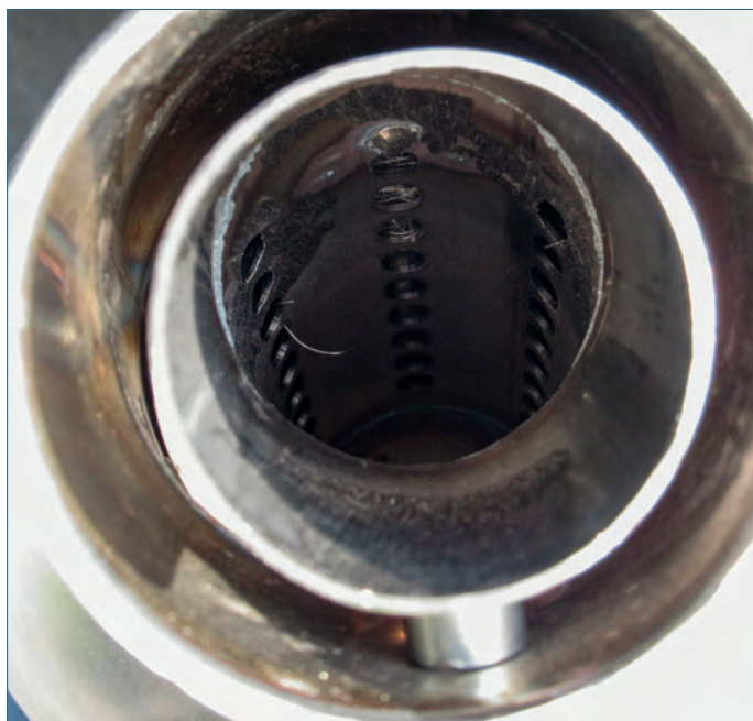
Klassischer Aufbau: lange, schlanke, runde Form, innen mit Lochblech und Dämmmaterial. So genannter „Dezilbel-Killer“ hinten angeschraubt
