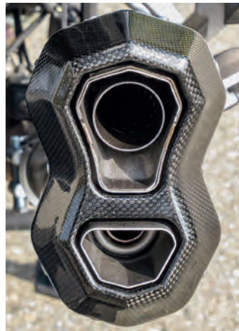
Die Form der Carbon-Endkappe erklärt die Bezeichnung „8“. Abdeckung am Verbindungsrohr ebenfalls aus Carbon
