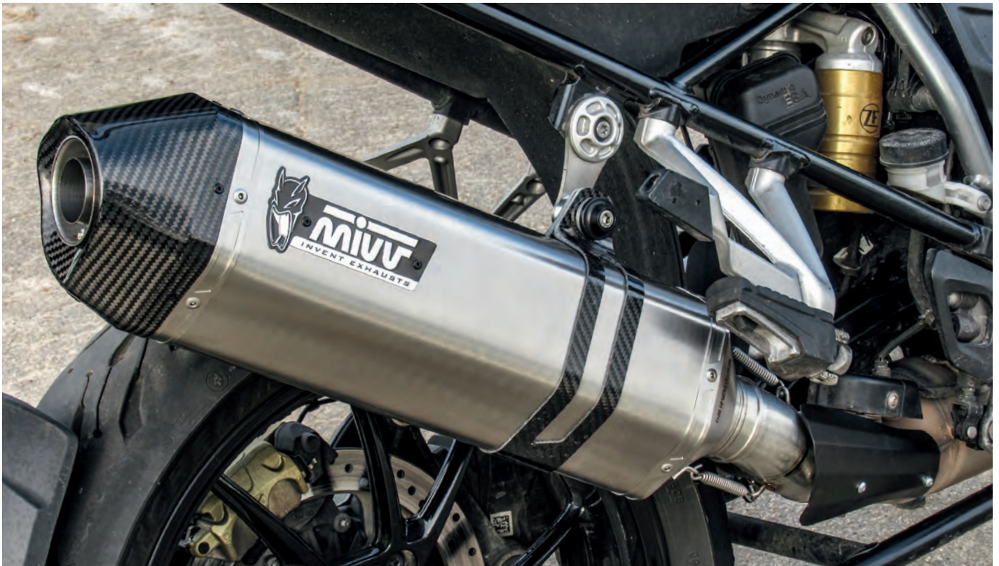
Aus Italien, aber trotzdem kaum lauter als original: der Speed Edge von MIVV. Mit Carbonschelle und insgesamt 3,2 Kilogramm leicht
