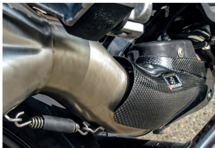
Die Form der Carbon-Endkappe erklärt die Bezeichnung „8“. Abdeckung am Verbindungsrohr ebenfalls aus Carbon
