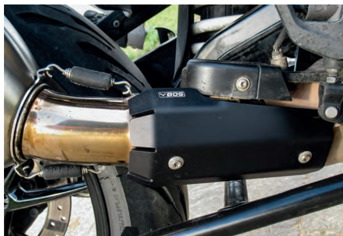
Saubere Konstruktion: zwei angeschraubte und miteinander verschraubte Haltetaschen aus Stahlblech, Distanzbuchse an der Aufhängung
