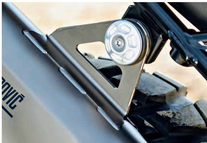
Angeschweißte Aufhängelasche, das erleichtert den Anbau. Auch an solchen Details ist qualitative Extraklasse zu erkennen
